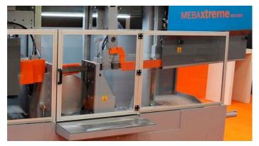
Die schlagkräftige Maschine-Sägeband-Kombination für den Sägedünnschnitt in Vergütungsstahl, die Günther + Schramm jetzt nutzt: Eine Mebaextreme 800-600 des Sägemaschinenherstellers Meba und das Sägeband Arion FG von Wikus.
