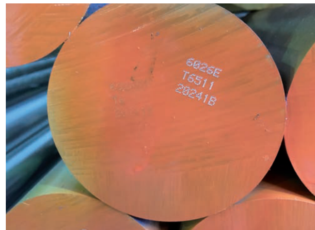
EN AW-6026 Lead Free: Günther + Schramm ergänzt sein Programm durch drei bleifreie Alu-Legierungen, gemäß den RoHS-Richtlinien
