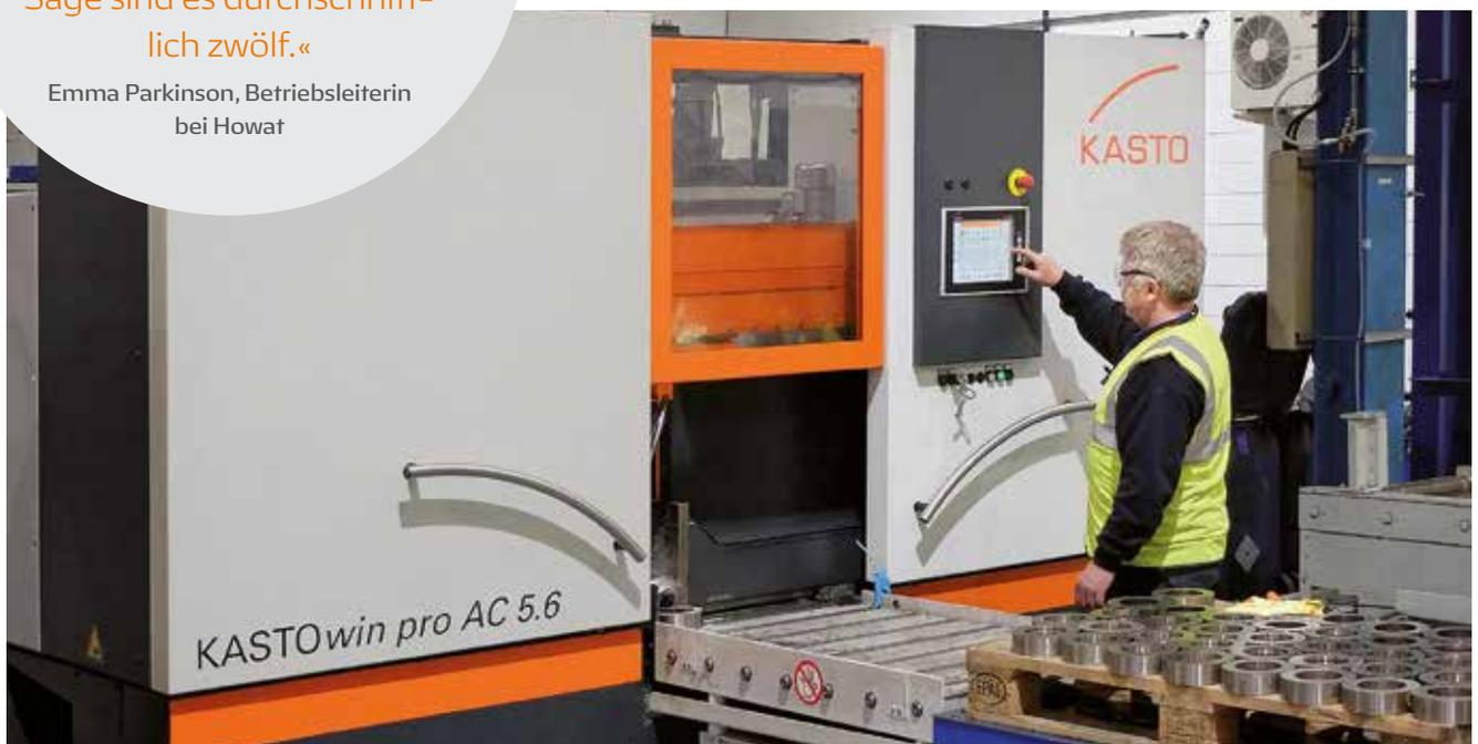
Die KASTOwin pro AC 5.6 ist eine Hochleistungs-Bandsäge, die für den Einsatz mit Bi- und Hartmetall-Sägebändern optimiert ist.
