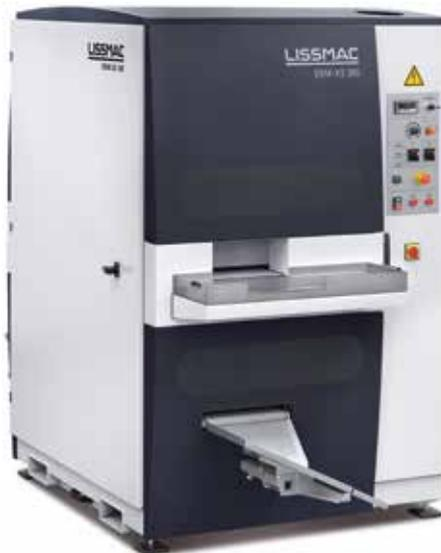
Sturm Blechverarbeitung investierte für die Kleinteilebearbeitung in eine SBM-XS, die sich nach Entwicklerangaben für eine beidseitige Entgratung und gleichmäßige Kantenverrundung von gestanzten, sowie laser- und feinplasmageschnittenen Werkstücken mit Abmessungen von 25 x 25 x 1 Millimetern bis maximal 200 x 200 x 15 Millimetern in nur einem Arbeitsgang eignet.
