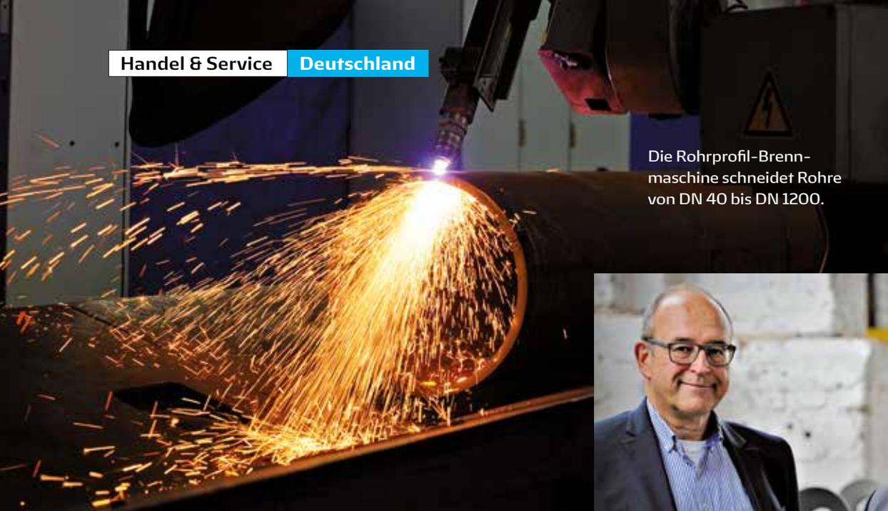
Die Rohrprofil-Brennmaschine schneidet Rohre von DN 40 bis DN 1200.
