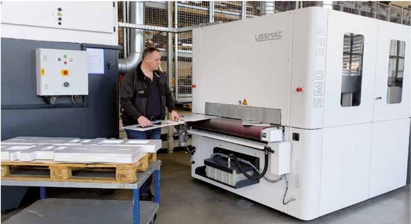
Auf dem Powergrip-Gurt der SMD 335, auf dem die Teile bei der Bearbeitung liegen, werden diese durch die hohe Haftkraft ohne Magnet oder Vakuum fixiert.
