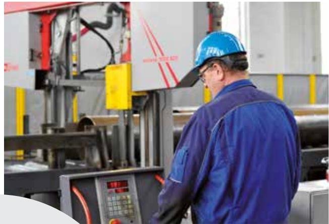
Zwei halbautomatische Bandsägen decken den Abmessungsbereich bis DN 800 ab.
