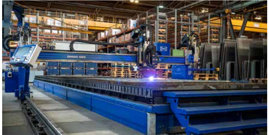
Das 5-Achs-System erlaubt Plasmafasenschnitte bis zu 50 Grad Winkel sowie höhere Genauigkeiten und Schnittqualitäten.
