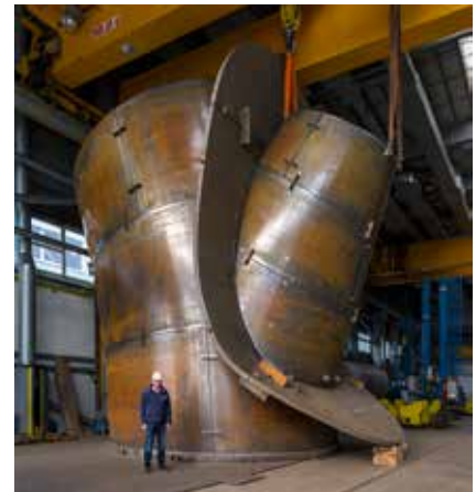
Probezusammenbau eines Abzweigers mit außenliegendem Kragenblech für das Pumpspeicherkraftwerk Nant de Drance
