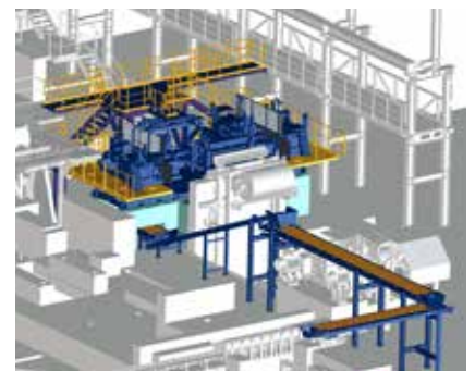
Die neue ASC-Besäumschere dient zum Besäumen von gebeizten sowie verzinkten Stahlbändern mit Zink- oder Zinkmagnesium-Beschichtung.
