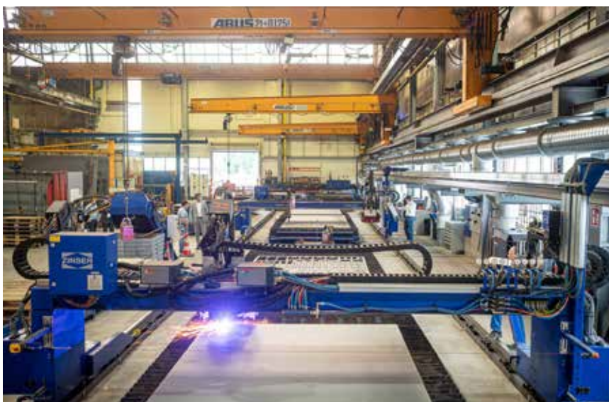
Die beiden neuen ZINSER 4025, jeweils mit einem Plasmafasenaggregat und einem Plasmabrenner gerade, auf einer 41-Meter-Laufbahn
