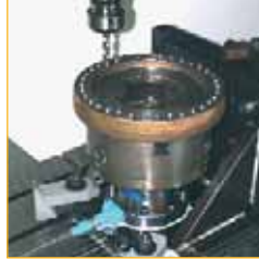
Deckel Maho DMC 70 V Bearbeitungszentrum Spindel: 15 000 U/min - 15 kW Ausstattung mit: Schnittleistungs- und Schnittkraftmesser (piezoelektrischer Kistler-Sensor)
