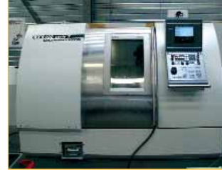
Gildemeister CTX 40 Drehmaschine mit digitaler Steuerung Spindel: 5 000 U/min - 20 kW Ausstattung mit: Schnittleistungsmesser Stabdurchmesser: 10 bis 80 mm
