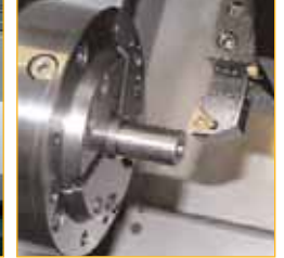
Gildemeister CTX 40 Drehmaschine mit digitaler Steuerung Spindel: 5 000 U/min - 20 kW Ausstattung mit: Schnittleistungsmesser Stabdurchmesser: 10 bis 80 mm
