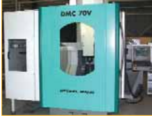
Deckel Maho DMC 70 V Bearbeitungszentrum Spindel: 15 000 U/min - 15 kW Ausstattung mit: Schnittleistungs- und Schnittkraftmesser (piezoelektrischer Kistler-Sensor)
